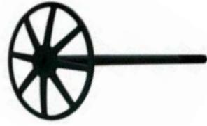
Zur Befestigung von: weichen und druckfesten Dämmstoffen wie z.B. Steinwolle, Glaswolle, Polystyrol (Styropor), PU-Hartschaumplatten, Holzwolleleichtbauplatten, Kokosmatten, Korkplatten, etc.
